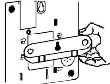
c) Choisissez l'endroit du mur sur lequel vous voulez fixer votre téléphone et vérifiez qu'il n'y a pas de tuyaux ou de câbles électriques à cet emplacement. NOTA les câbles électriques sont normalement en position verticale au dessus ou en dessous des appliques et des prises. Ne placez donc pas votre téléphone directement au dessus ou en dessous d'une applique ou d'une prise électrique à moins que vous soyez certain de ne pas pouvoir abîmer les câbles avec les vis de fixation.
