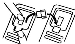
b) Fixez le support mural (fourni avec votre appareil) sous la base de votre téléphone, en introduisant les taquets du support dans les encoches de la base du téléphone prévues à cet effet.
