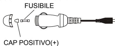
NOTA: non estrarre il cap positivo(+) quando si sostituisce il fusibile.
