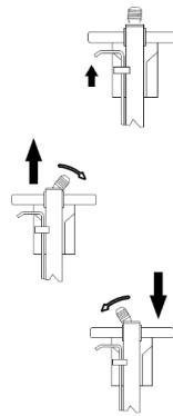
**WICHTIG:** Der Hebel muß sich immer in horizontalen (waagerechten) Position vor dem Absenken befinden. Es besteht die Gefahr einer Beschädigung des Hebels / Chassisrahmens, falls ein Fahrzeug abgesenkt wird, ohne daß der Hebel sich in horizontalen (waagerechten) Position befindet.
